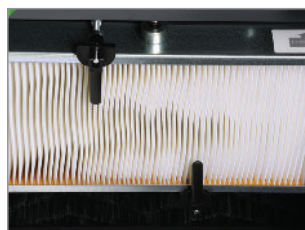
ELEKTRYCZNE OTRZĄSIANIE FILTRA
